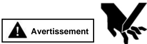
Cette machine est équipée d'une lame rotative coupante capable d'amputer une main ou un pied, et de lancer des objets. Éloignez les pieds et les mains des ouvertures pendant que la machine est en fonctionnement. L'inobservation de ces instructions de sécurité peut être à l'origine de blessures graves, voire mortelles.
