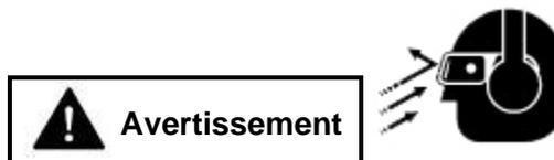
Portez des protections auditives et oculaires en faisant fonctionner cette machine ou si vous vous trouvez dans un rayon de 25 m. Des objets projetés peuvent provoquer de sérieuses blessures aux yeux en ricochant.
