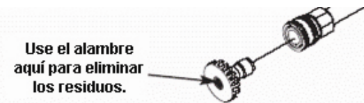
Figura 13 — Mantenimiento de la Boquilla
